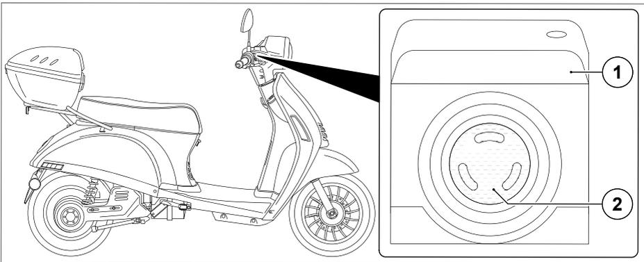
Abb. 12 Bremsflüssigkeit prüfen
