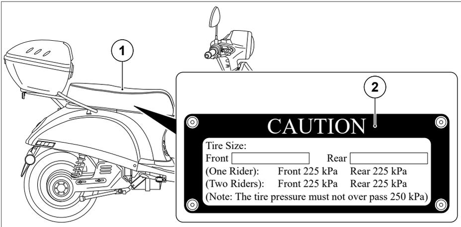
Abb. 14 Reifenluftdruck - Hinweisschild
