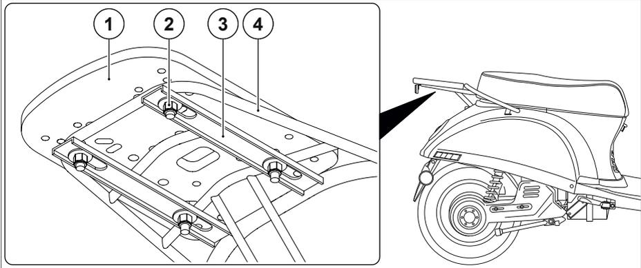
Abb. 10 Grundplatte montieren
